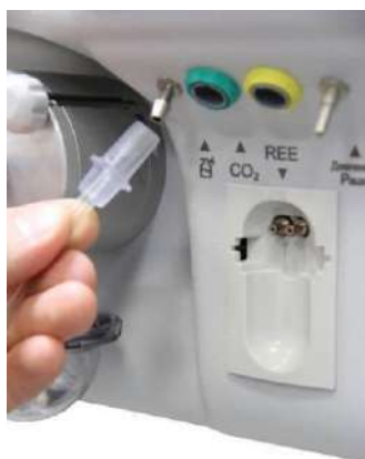
Рисунок 4.15 – Подключение соединительной трубки небулайзера к штуцеру на передней панели аппарата
