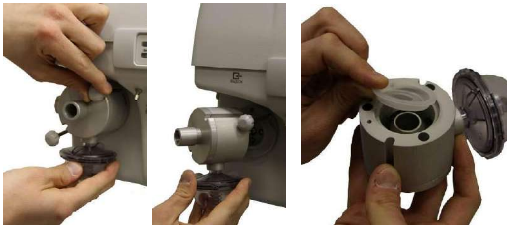
Рисунок 6.3 – Отсоединение съемной части клапана выдоха
