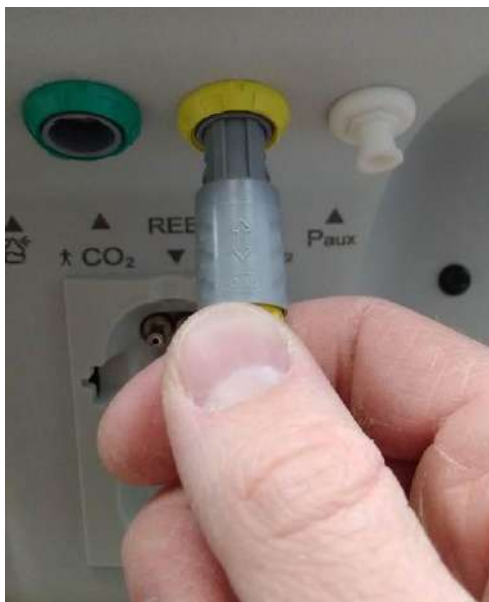
Рисунок 5.6 – Подключение пульсоксиметрического датчика к аппарату
