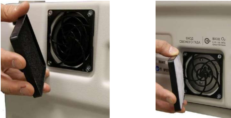
Рисунок 6.1 – Очистка и замена пылевого фильтра
