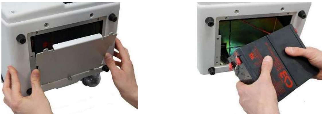
Рисунок 6.5 – Замена встроенных аккумуляторов
