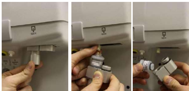
Рисунок 6.4 – Замена датчика \text{FiO}_2
